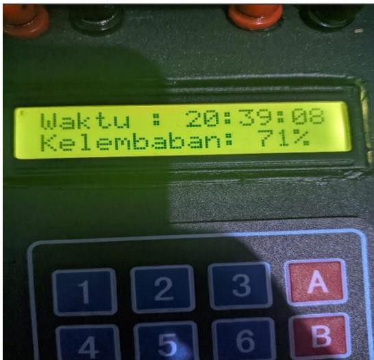
Gambar 8. Modul RTC dan Sensor Tanah Pengujian Penyiraman
